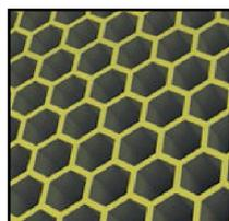
L'accumulateur d'énergie céramique de haute technologie, dont l'efficacité de régénération peut atteindre 97%, assure la récupération de la chaleur de l'air vicié pour chauffer ou refroidir le flux d'air soufflé. Grâce à sa structure cellulaire, ce régénérateur unique présente une grande surface de contact avec l'air et des propriétés élevées de conduction et d'accumulation de la chaleur.
